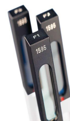
Figura 2. Filtros de vidrio de densidad neutra
